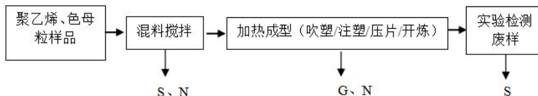
图 3-1 色母粒实验加工项目工艺流程及产污环节图-实验室
